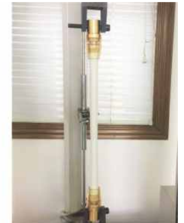
试验过程中铝塑管断裂
